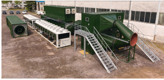
Bild 8: Werksaufbau der Schachtbewetterungsanlage für den Service-Shaft
