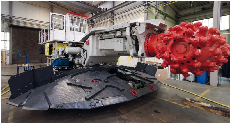
Fig. 4: Von CST überholte Teilschnittmaschine
