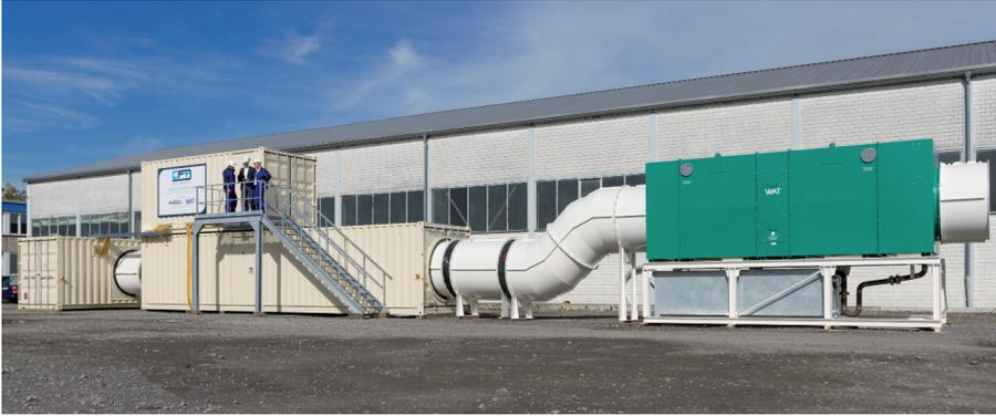
Werksaufbau der Schachtbewetterungsanlage für Schacht 2
