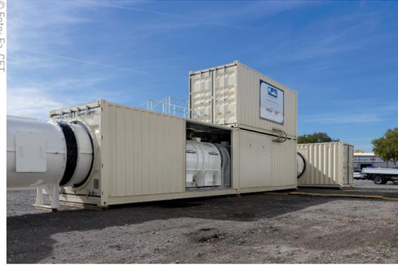
Geöffnete Revisionsöffnung des Lüftercontainers, dahinter Axialventilatoren
