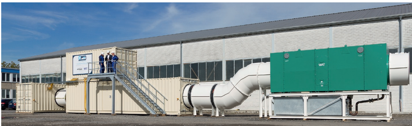
Рис. 5: Заводская сборка шахтной вентиляционной системы для ствола 2.
