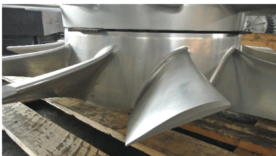
Bild 11: Oberflächenoptimiertes Flügelrad gegen Staubablagerungen
