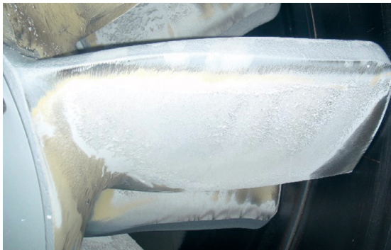
Bild 10: Verschleiß durch Staub
