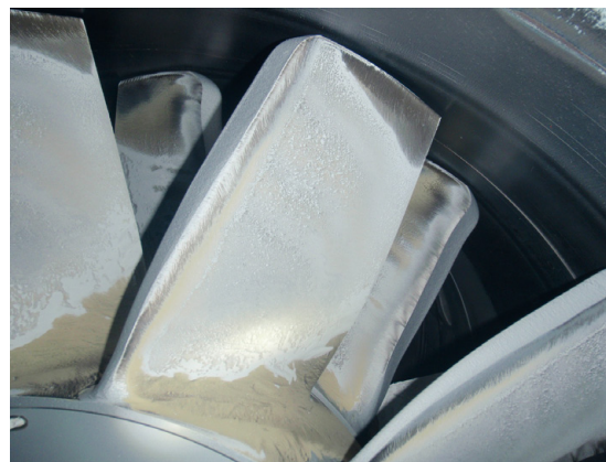
Bild 11: Starker Abrieb an den Flügelspitzen
