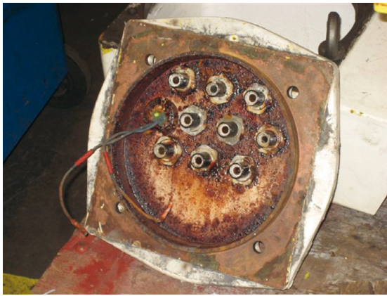
Bild 18: Chemische Korrosion im Inneren eines Ventilators
