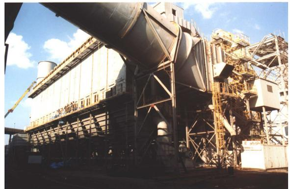
CFT Filteranlage zur Entstaubung eines ägyptischen Stahlwerks
