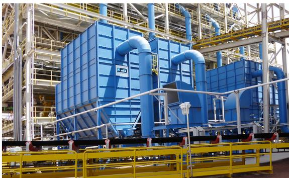
Installierte Deichmann Schlauchfilteranlagen für die Entstaubung einer Eisenerz-Separation in Mauretanien
