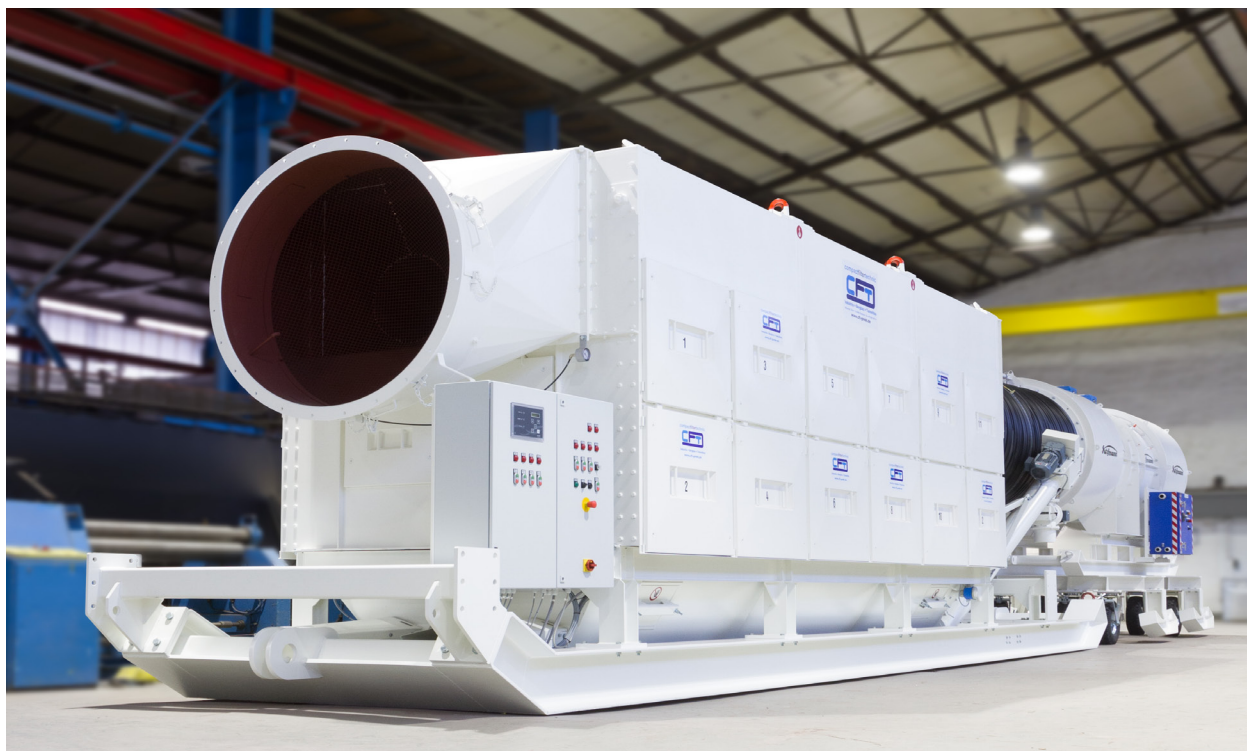
在格拉德贝克工厂即将要出厂的 CFT 干式除尘器、Korfmann 风机和连接风筒
