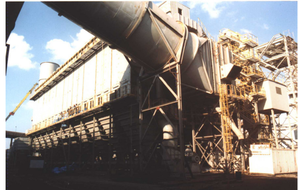
上世纪 90 年代在埃及钢厂中使用的 CFT 除尘器
