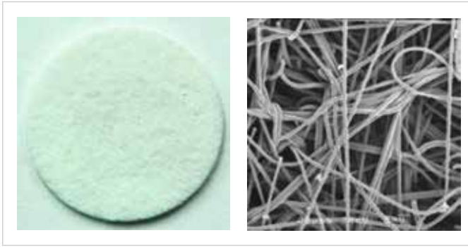
Bild 4 Filterprobe und Rasterelektronenmikroskop-Aufnahme des Filtermaterials Filter sample and scanning electron microscope image of the filter material
