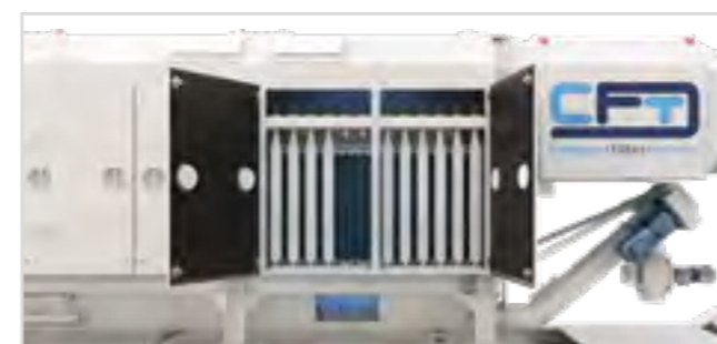
CFD z koszem zbierającym pył i przenośnikiem ślimakowym wyładowczym
